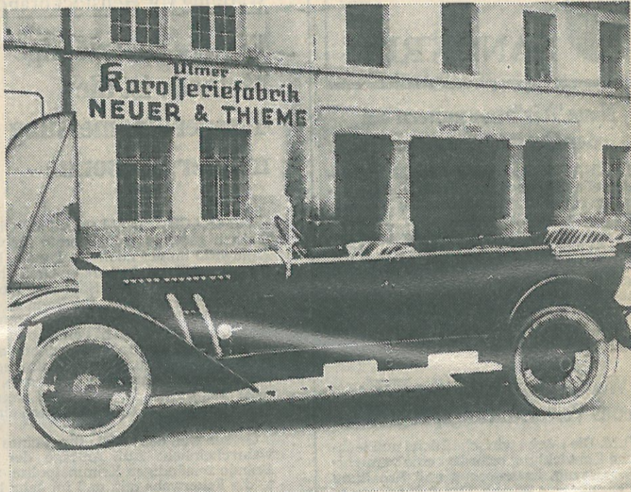
Lang, länger, am längsten wirkt dieser Steiger aus dem Karosseriewerk Neuer & Thieme in Ulm. Die Karosserieform heißt „Torpedo“.
