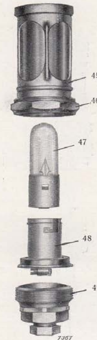
Auswechseln der Glühlampe bei der Nummerlaterne JN 4/9.
