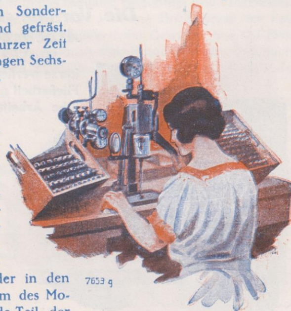
Jede Bosch-Kerze wird vor der Verpackung unter einem Druck von 25 Atmosphären auf Gasdichte geprüft.
