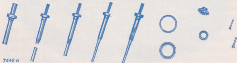
Der Werdegang der Mittelelektrode und der Masseelektroden. Rechts die Dichtungsringe und die Anschlußmutter.
